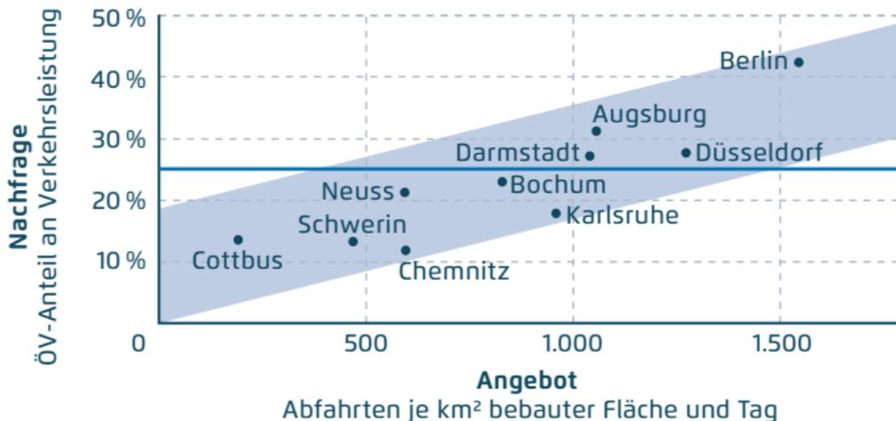
In Städten mit mehr als **einem Viertel** der Verkehrsleistung im ÖV fahren Busse und Bahnen mindestens in einem 10-Minuten-Takt. Das entspricht mindestens 900 Fahrten pro km² und Tag.
